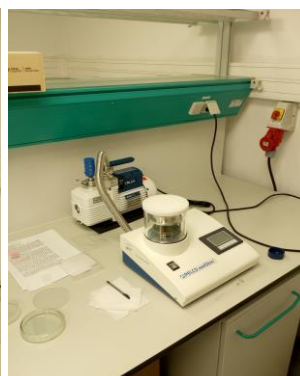
Urządzenie do przygotowania siatek TEM tzw. glow discharger
